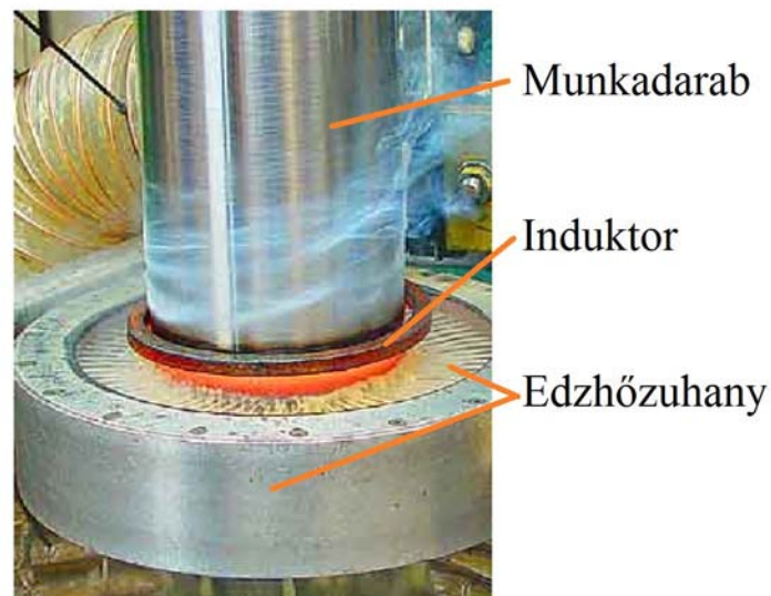
14. ábra. Tengely indukciós edzése
