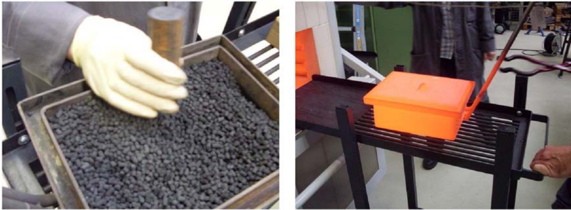
15. ábra. Munkadarab becsomagolása a szilárd cementáló közegbe, és a doboz kihúzása a kemencéből a szénítés után
