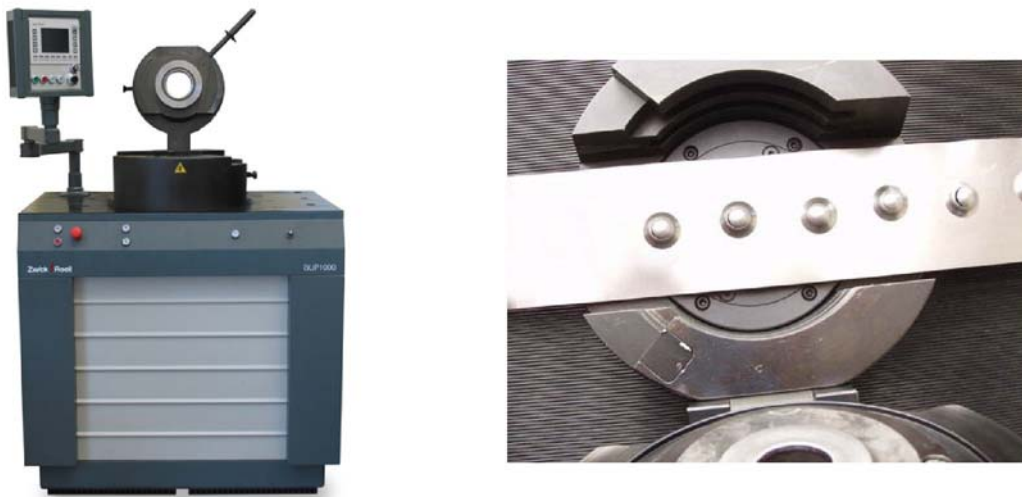
12. ábra. Berendezés az Erichsen-próbaéhoz és a vizsgálat eredménye
