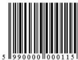
8. ábra. A vonalkód felépítése Magyarországon gyártott termékek esetében
