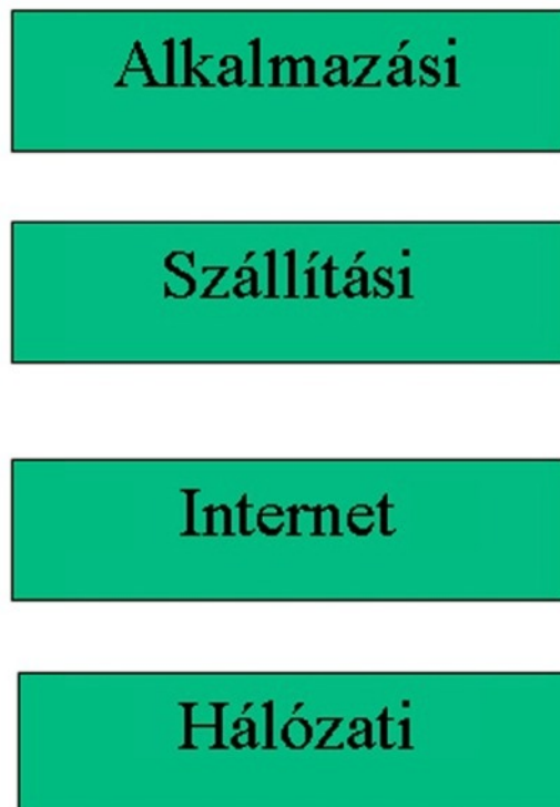
8. ábra. A TCP/IP modell 4 rétege
