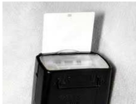
6. ábra. Kisvaku beépített fényvisszaverő kártyával
