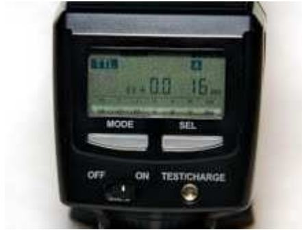
3. ábra. Kisvaku kijelzője TTL üzemmódban
