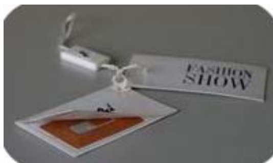
29. Fügőcímkébe elrejtett áramkör 18
