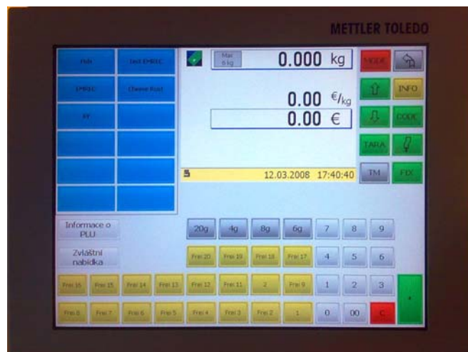
24. ábra Két kijelzős érintőképernyős mérlegek 18
