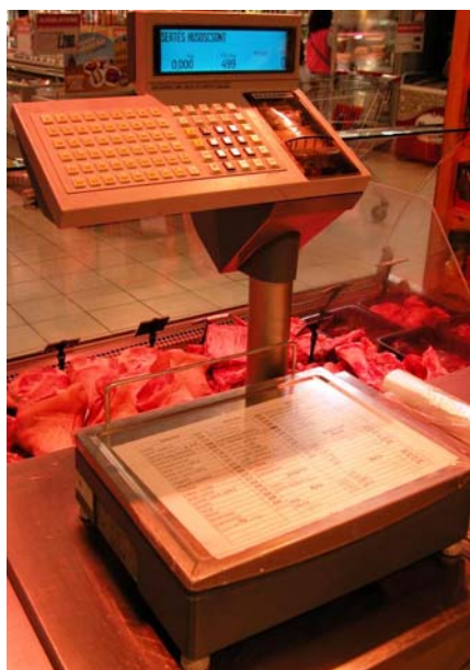
20. ábra Digitális árcímkét készítő asztali mérleg
