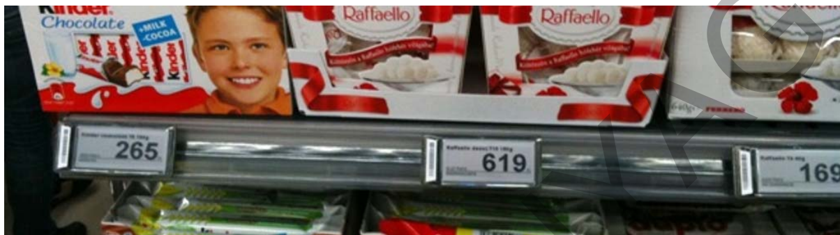
4. ábra Polcsínben elhelyezett elektronikus polccímke 3
