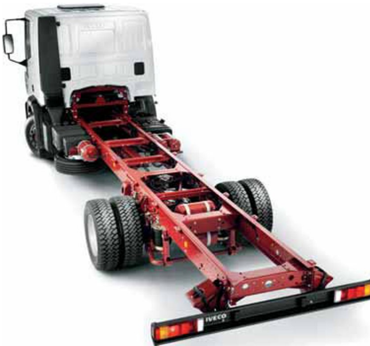
17. ábra. Motorral és fülkével ellátott alváz
