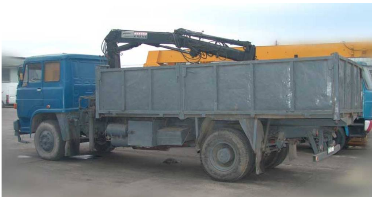
5. ábra. Tehergépjármű rakodószerkezettel
