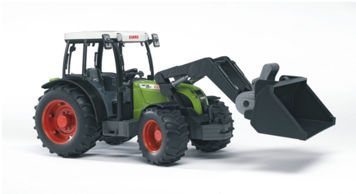
4. ábra. Vontató homlokrakodóval felszerelve
