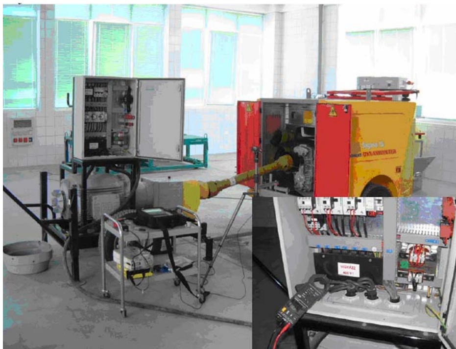
8. ábra. A villamos motor mérési összeállítása 3
