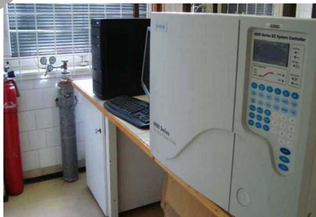
14. ábra. A gázkromatográfiás elválasztás, láng-ionizációs detektálás készüléke
