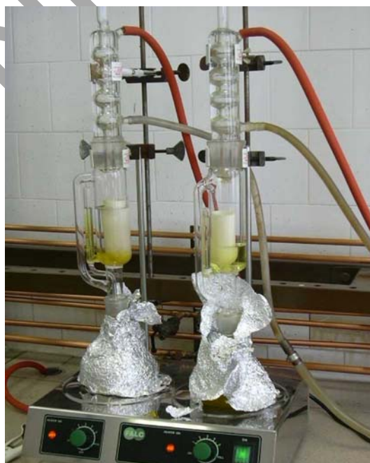
6. ábra. Laboratóriumi vizsgálatok extraháló készüléke a Soxhlet-extraktor
