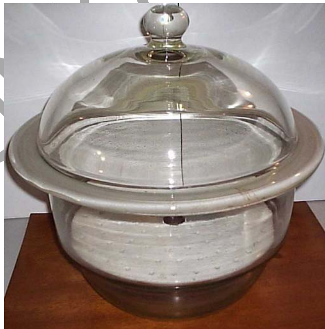
7. ábra. Exszikkátor az anyagok "szárazon" tartására
