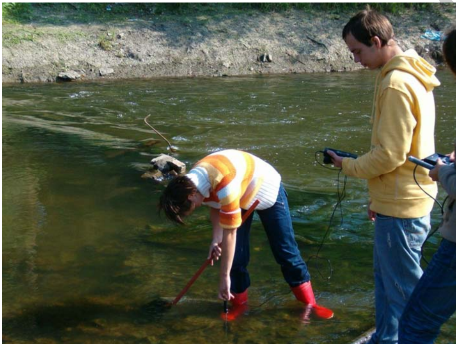
6. ábra: Hőmérséklet mérése a helyszínen
