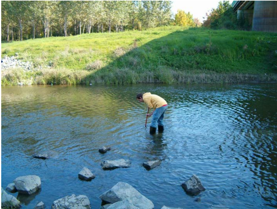
14. ábra: BISEL mintavétel kézi hálóval
