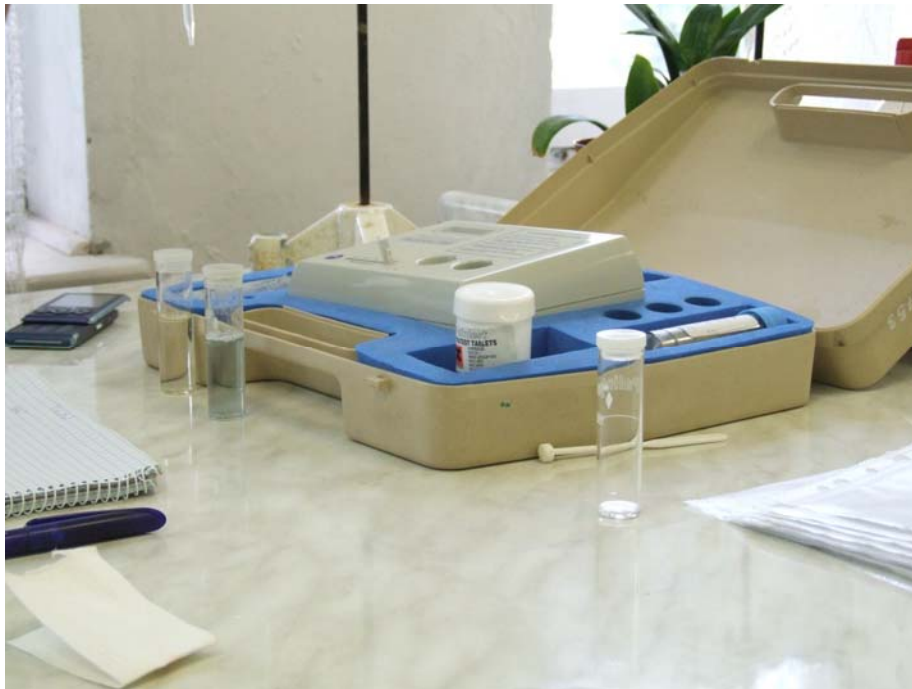
13. ábra: Foszfát meghatározás fotométerrel
