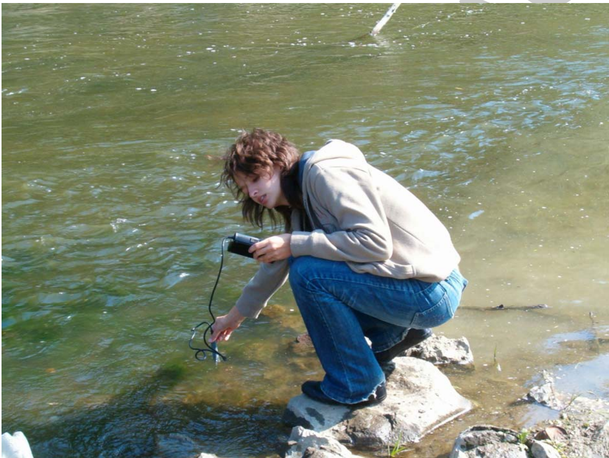
11. ábra: Vezetőképesség mérése a helyszínen
