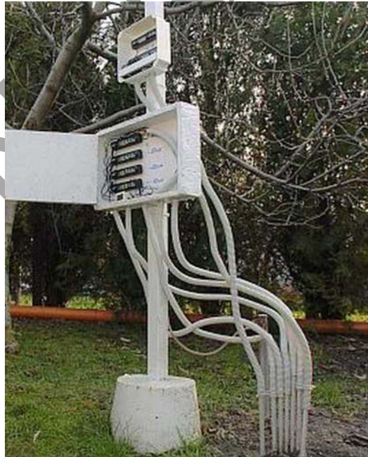
12. ábra. A készülék talaj felszínén és több ponton, mélységében is méri a hőmérsékletet
