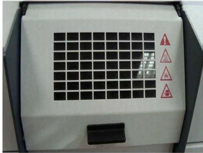
4. ábra. Az égésteret elzáró védőburkolat, és a veszélyt jelző piktogramok
