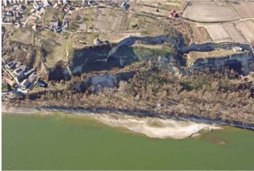
18. ábra. A dunaszekcsői magaspart rogyásos suvadása 2008. február 17-én 12
