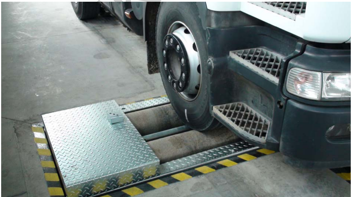
12. ábra. Fékberendezés diagnosztikai vizsgálata
