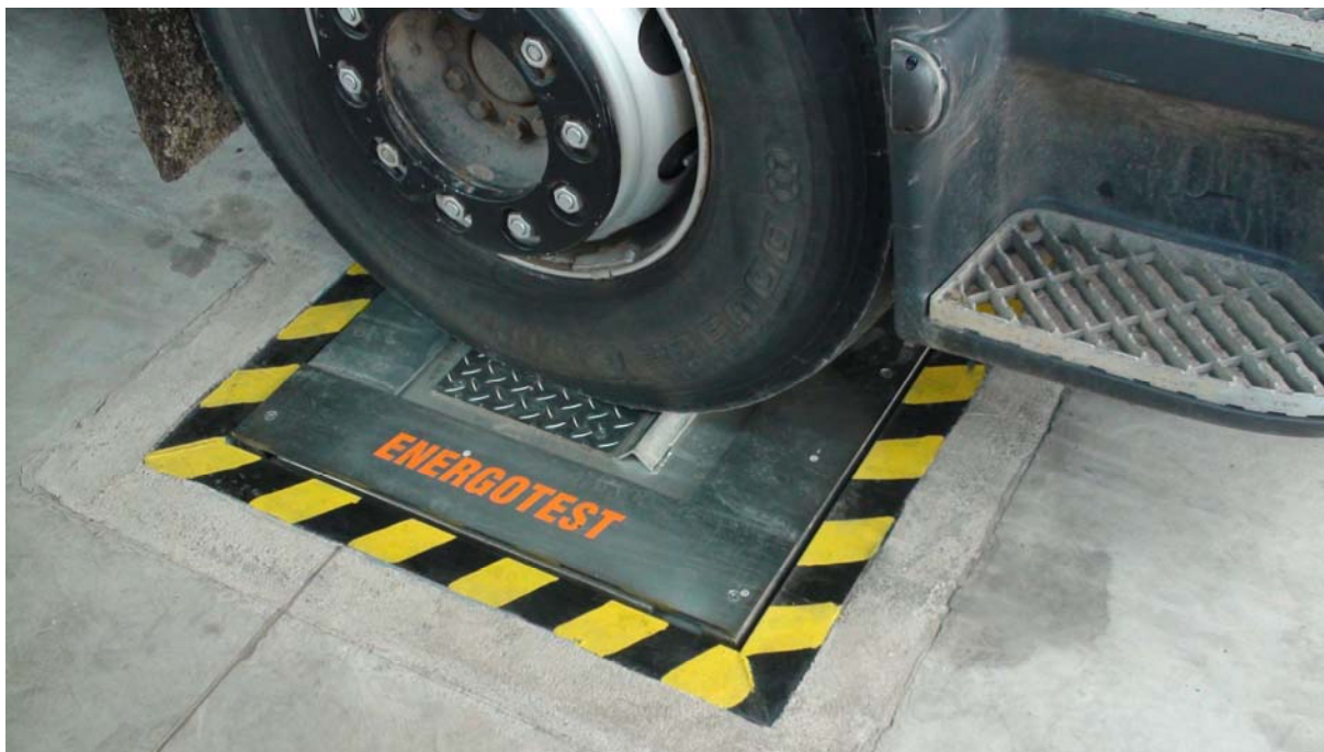
14. ábra. Lengéscsillapító vizsgálat
