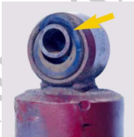
7. ábra. Elhasználódott szilentblokk 6
