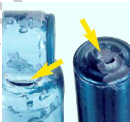
11. ábra. Csukló repedés 10
