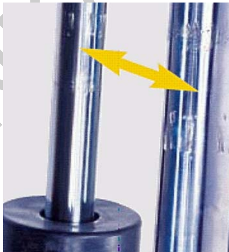
6. ábra. Sérült dugattyúrúd 5
