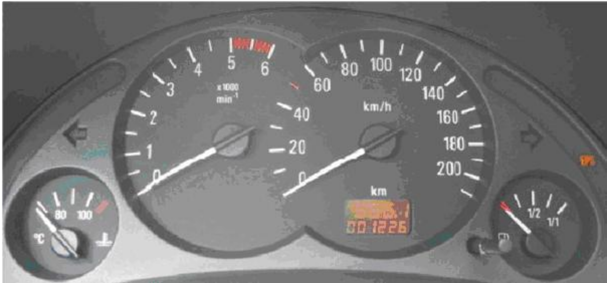
20. ábra. Az elektromos kormányszervó hibájára figyelmeztető lámpa (EPS)
