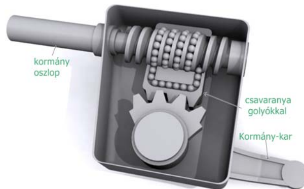
7. ábra: Csavarorsós kormánymű golyóssal
