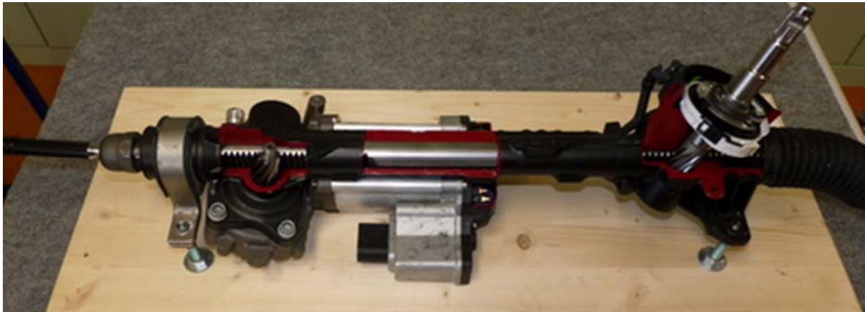
15. ábra: Elektromechanikus kormányberendezés metszet 15
