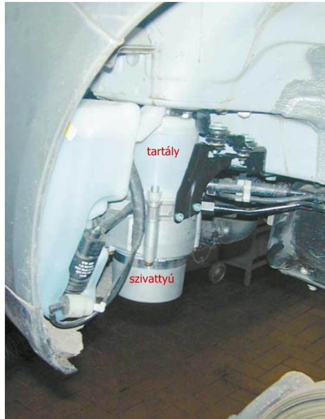
13. ábra: elektrohidraulikus szervokormány hidraulikaszivattyúja és tartálya 13
