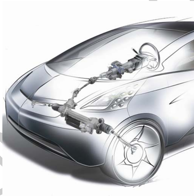
8. ábra: Fogasléces kormányművel szerelt kormányberendezés 8
