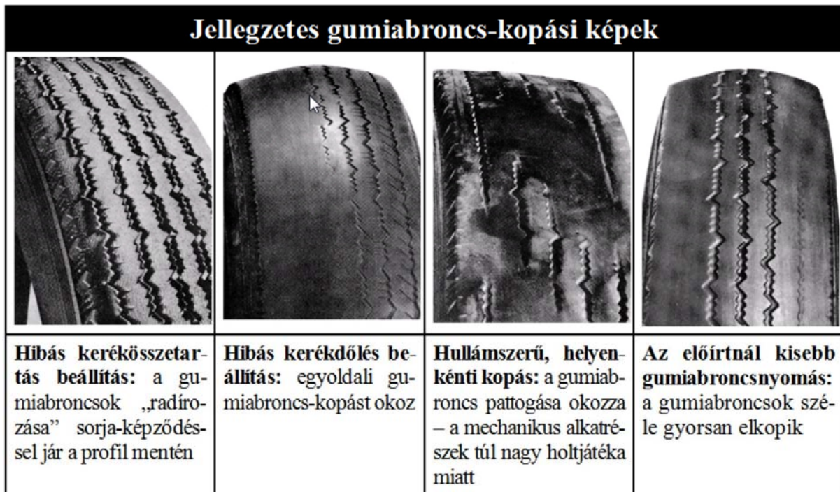
18. ábra. A futómű-hibákra utaló jellegzetes gumiabroncs-kopási képek 17
