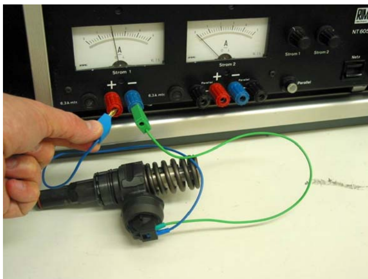
14. ábra. Adagoló porlasztó elektromos vizsgálata
