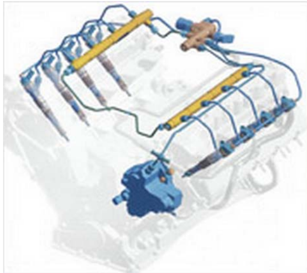
20. ábra. Közös nyomócsöves rendszer elvi képe (VW)
