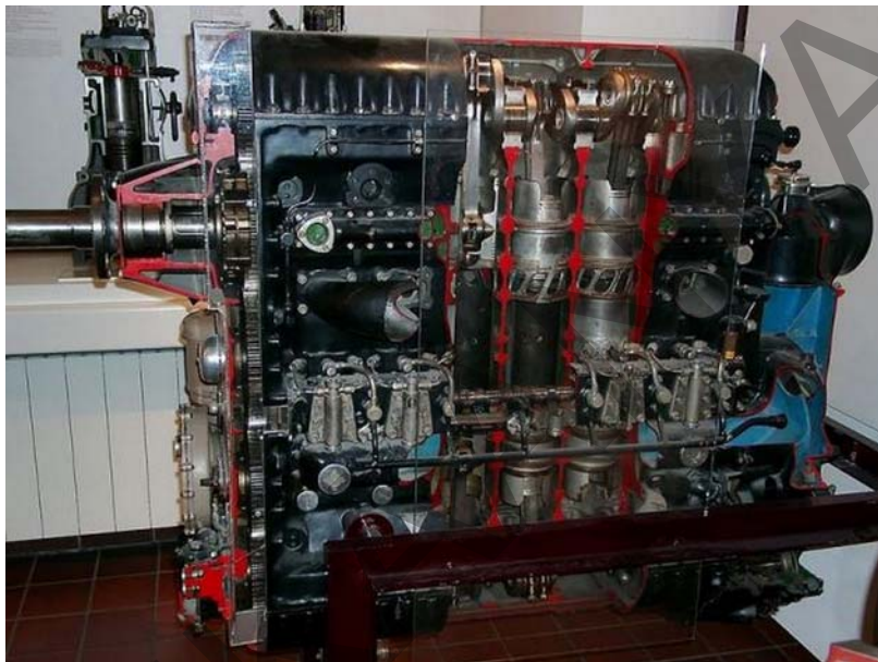
15. ábra. Junkers jumo 205 ellendugattyús kétütemű repülőgép dízelmotor
