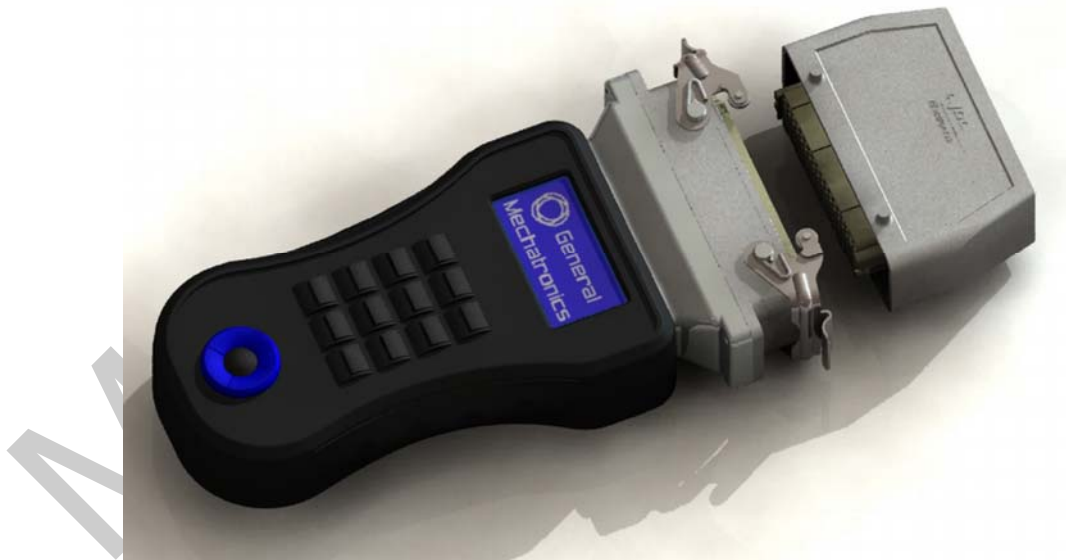
3. ábra. AUDI-hoz fejlesztett kompakt párhuzamos diagnosztikai egység
