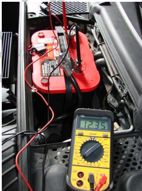
33. ábra. Akkumulátor terheletlen kapcsolásfeszültségének mérése
