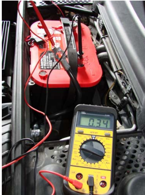
32. ábra. Akkumulátor szivárgási áramának mérése
