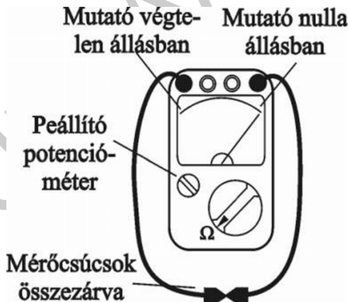
24. ábra. Ohm-mérő nullázása méréshatár váltáskor és mérés előtt
