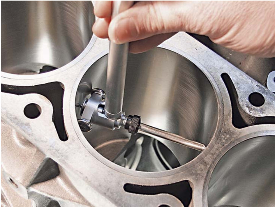
20. ábra. Henger mérése indikátorórával
