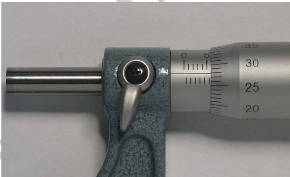
16. ábra. Mikrométer által mért érték leolvasása
