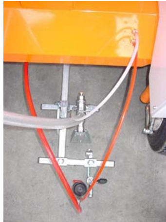
16. ábra. festőgép festékszóró berendezés
