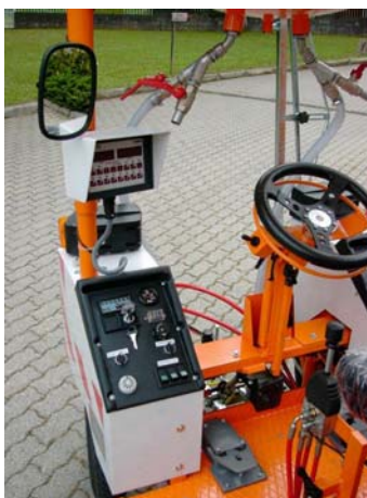
15. ábra. festőgép vezérlőautomatika
