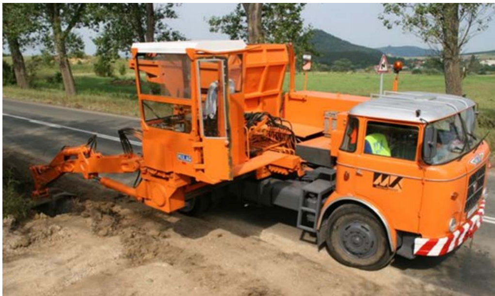
4. ábra. Mulag árokászó és javító célgép
