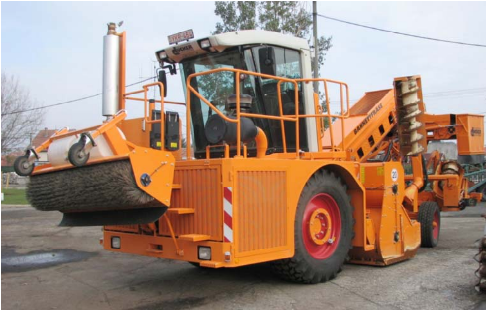
2. ábra. Korszerű padkanyeső gép
