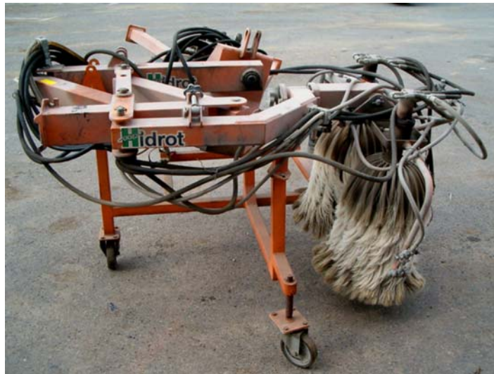
9. ábra. UNIMOG eszközhordozó alapgépre szerelhető korlátmosó adapter
