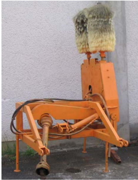
7. ábra. Oszlopmosó adapter
