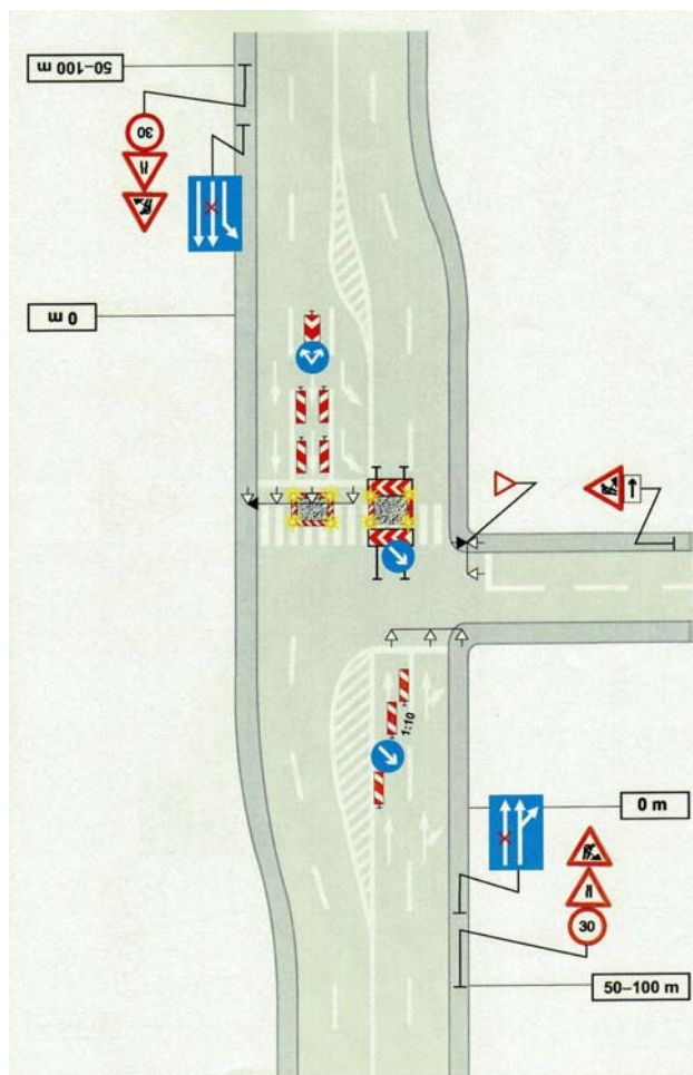
13. ábra. Munkaterület kialakítása: Jelzőlámpás kereszteződés háromütemű átvágása irányonként több forgalmi sávós belterületi úton II. ütem 13
