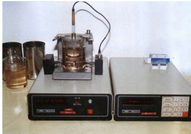
10. ábra. A bitumen lágyuláspont vizsgálata 8
