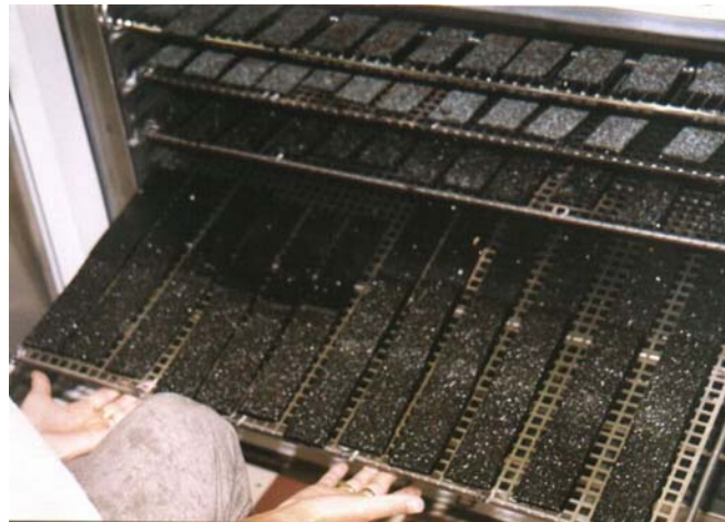
12. ábra. A bitumen öregítési vizsgálata 10
