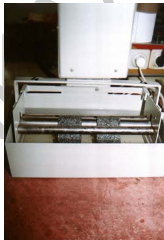
11. ábra. A bitumen töréspont vizsgálata 9
