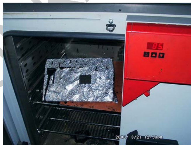
13. ábra. A bitumen hőállósági vizsgálata 11
