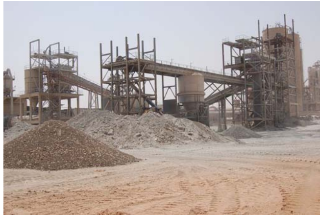
6. ábra. Az anyagok szállítása a cementgyárban szállítószalagokkal 5
