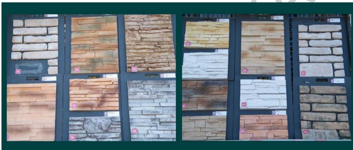
5. ábra. Esztétikus betonkő burkolások kialakítási módjai
