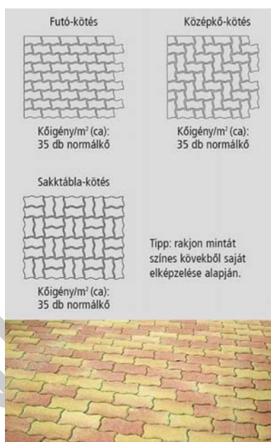
17. ábra. Betonkövek fektetési mintázata, kötése 10
