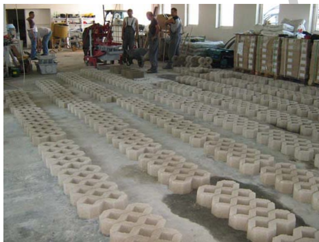
19. ábra. Betonkövek kisüzemi gyártása 12
