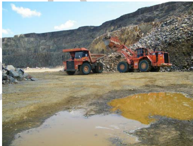
7. ábra. Tállya andezitbánya, a lerobbantott kövek felrakása
