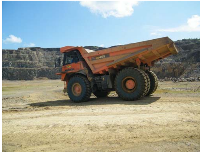
8. ábra. Tállya, andezitbánya, a lerobbantott kövek bányán belüli szállítása a törőhöz
