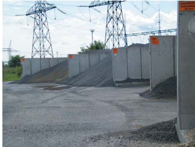
14. ábra. Felsőzsolca, Ipari park, Colas aszfalttelep, a telepre a bányából történő beszállításkor a zúzottkő anyagot frakciónkénti elválasztva a depókba helyezik el, a depókon a származási helyet, és a frakció megnevezésének jelölése
