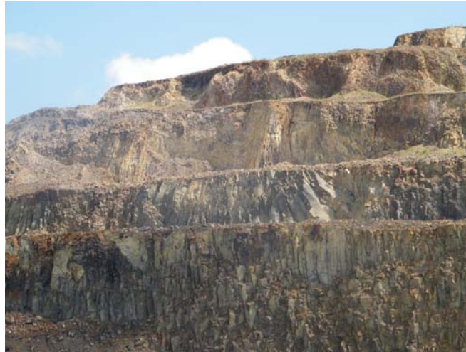
5. ábra Tállya andezitbánya, munkaszintek kialakítása
