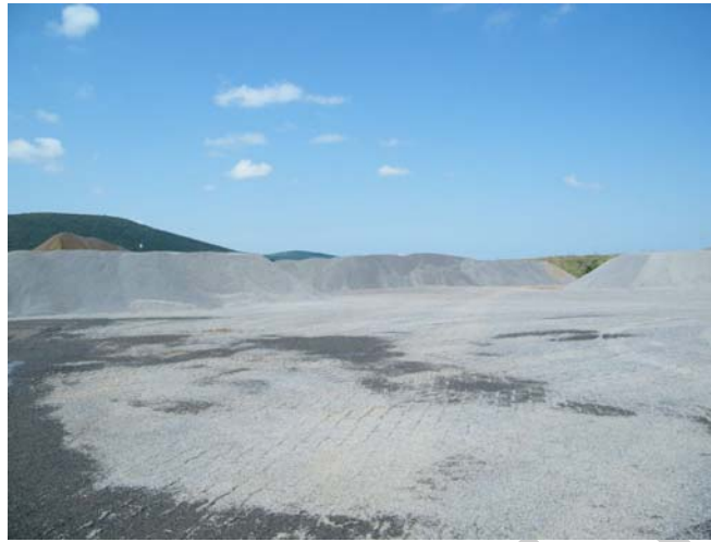
12. ábra. Tállya andezitbánya, a késztermékek tárolása, frakciónként elkülönítve és megjelölve
