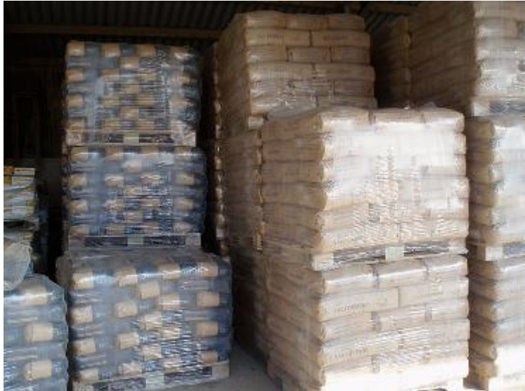
28. kép Zsákolt cement tárolása
