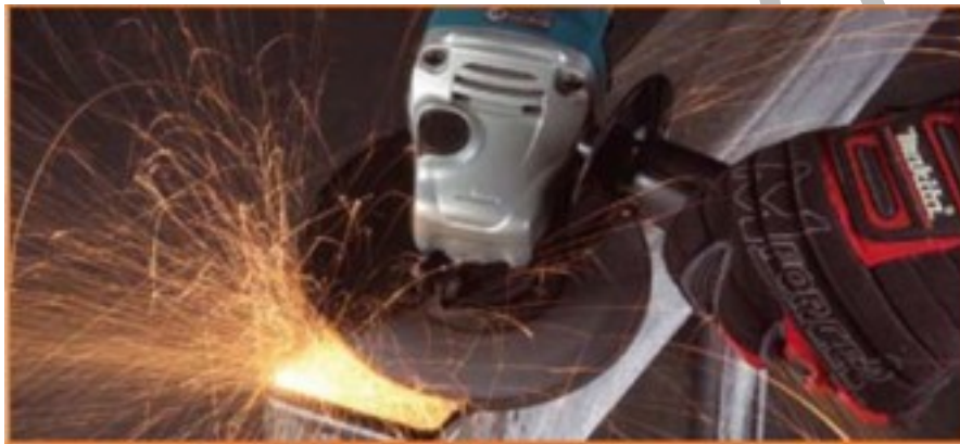
59. ábra: Vázszerkezet köszörülése
