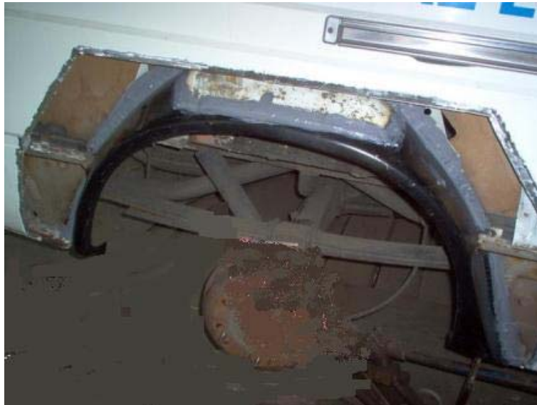
8. ábra Csatlakozó felületek javítása
