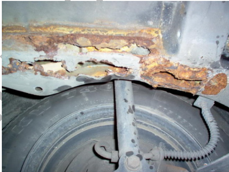
1. ábra Korrózió okozta károsodás
