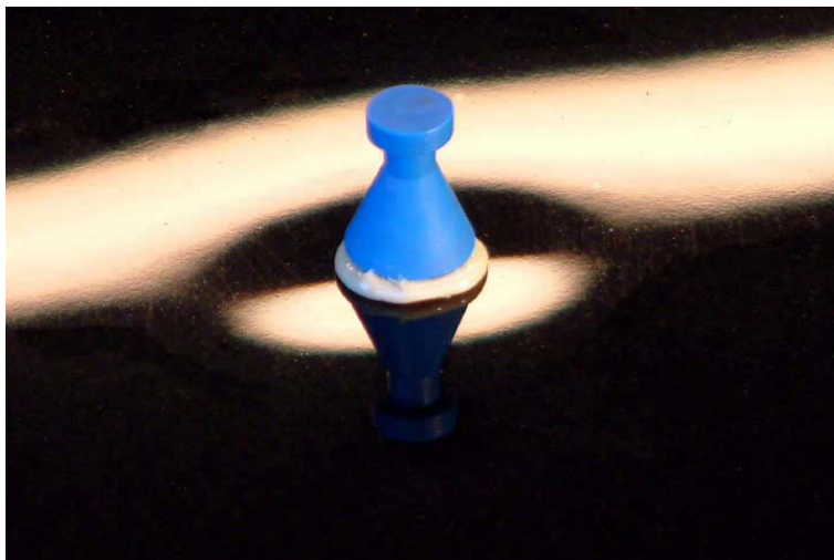
14. ábra Hiba megállapítás kihúzó babák szakszerű felragasztása
