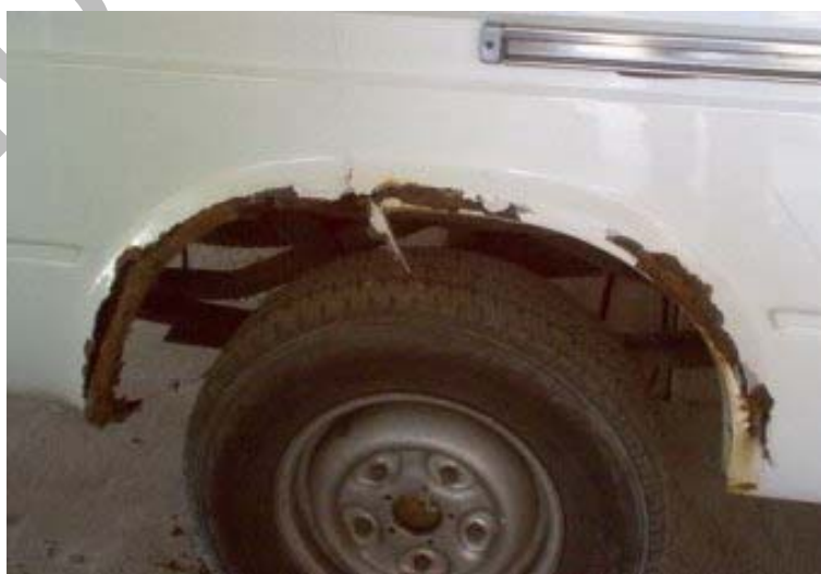
5. ábra Korrózió okozta károsodás
