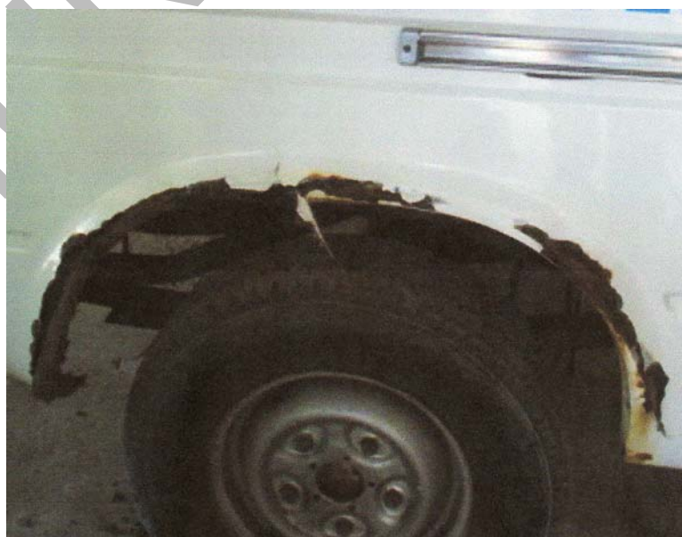
5. ábra Korrodált sárvédő ív.
