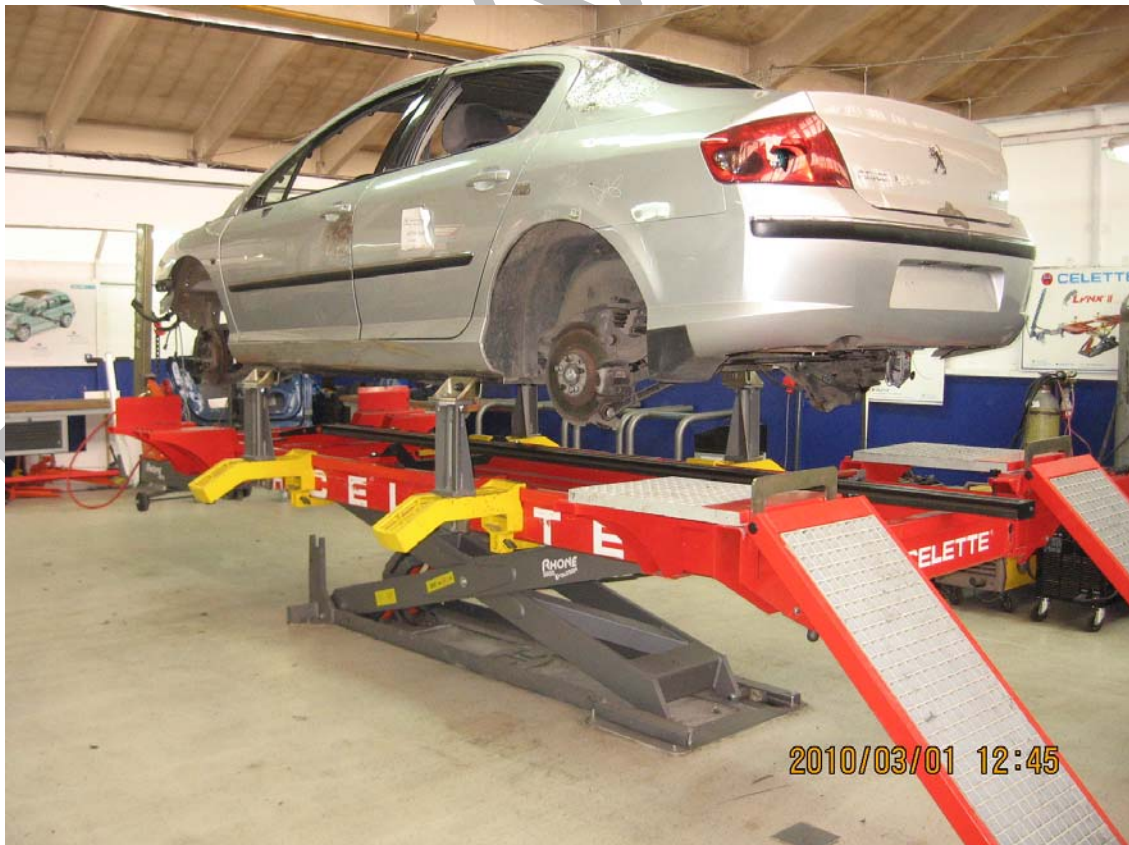
15. ábra A gépjármű rögzítése a huzatópadon.
