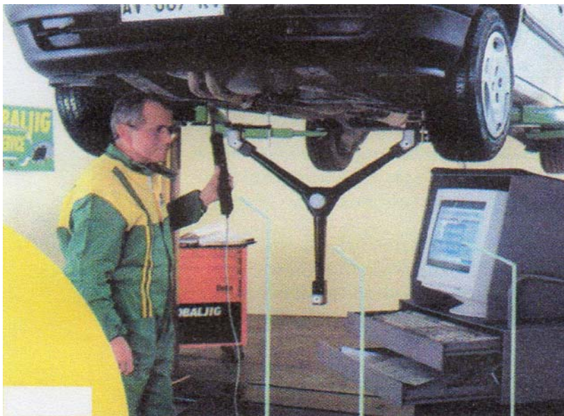
10. ábra: Kárfelmérés GDS műszeres méréssel.
