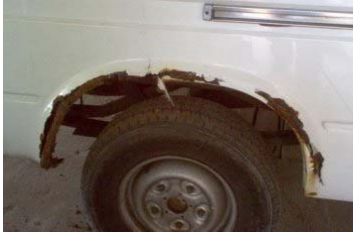
1. ábra. Korrózió okozta károsodás
