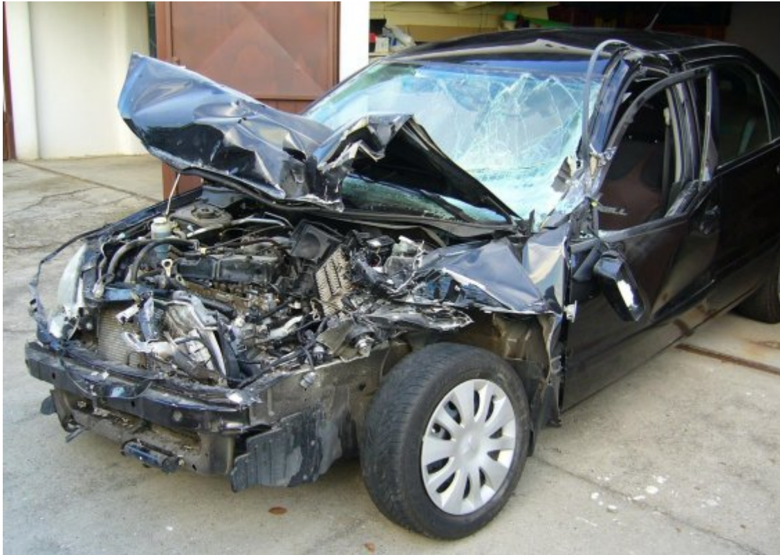
4. ábra. Súlyosan sérült karosszéria
