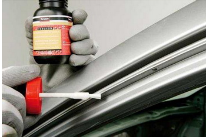
9. ábra. Rozsda átalakítás vegyi reakció segítségével
