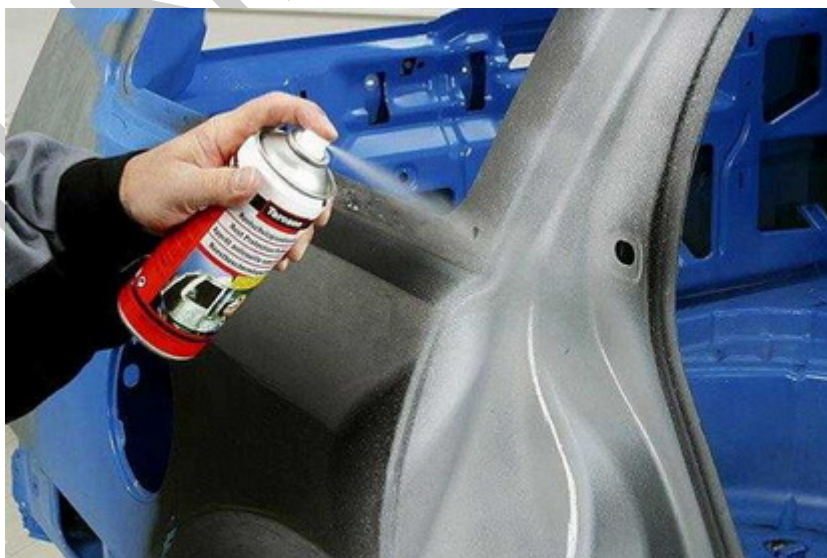
6. ábra. Alapozó felhordás
