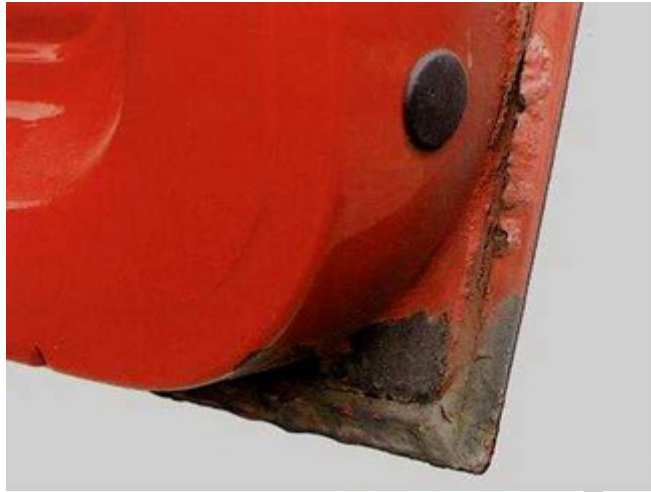
4. ábra. Esztétikumot rontó korróziós kár
