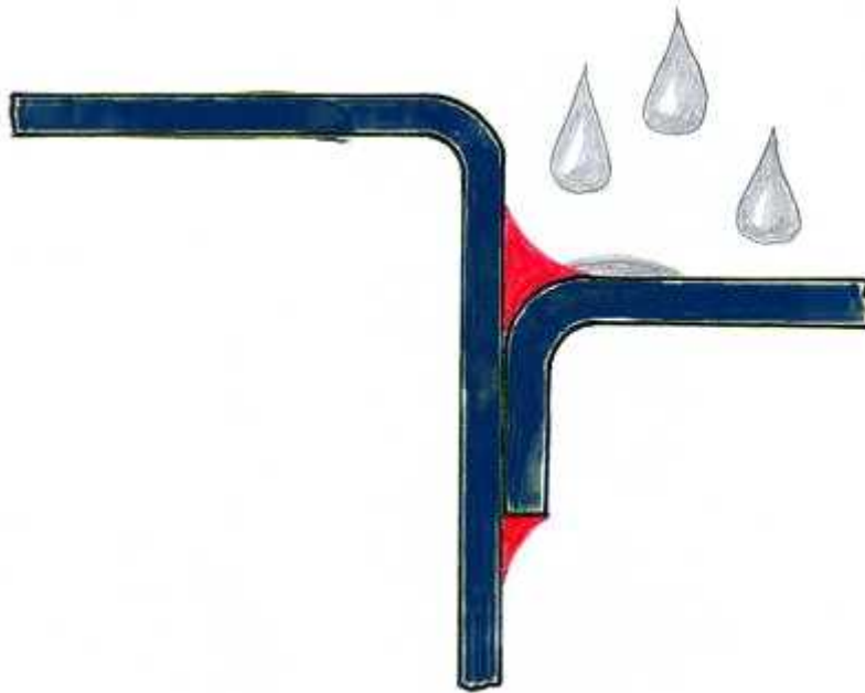
10. ábra. Hegesztések, átlapolások védelme tömítés alkalmazásával
