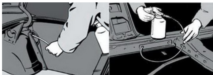
27. ábra. Üregvédelem rugalmas, hosszú szondával
