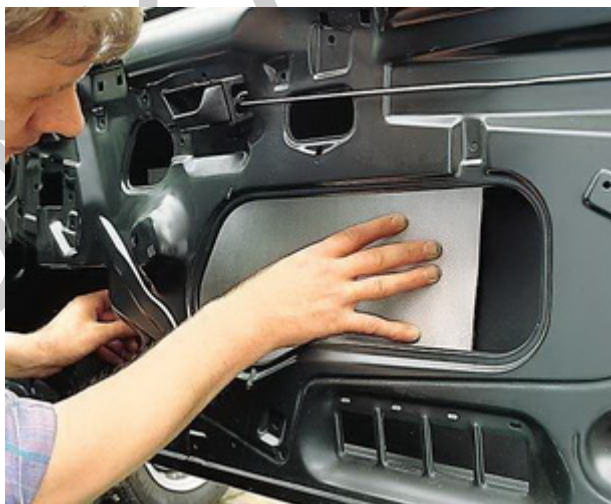
32. ábra. Alumínium szövettel bevont zajcsökkentő felragasztása
