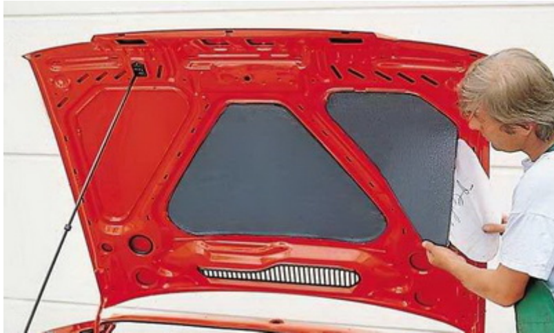
33. ábra. Motorháztető zajcsökkentő szigetelése
