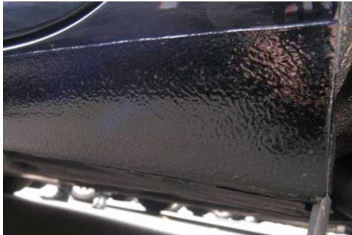
14. ábra. Gépjármű küszöbének védelme kőfelverődés ellen
