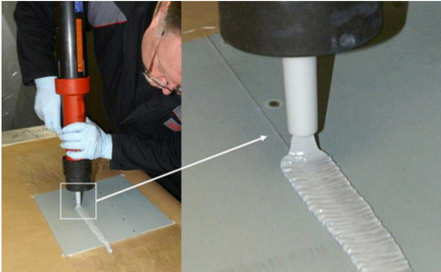
13. ábra. Kézi szórt tömítési technika
