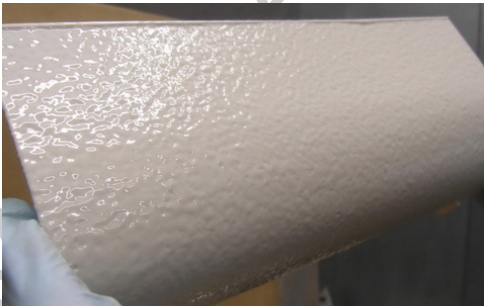
16. ábra. Vizes bázisú termékkel helyreállított kőfelverődés elleni védelem
