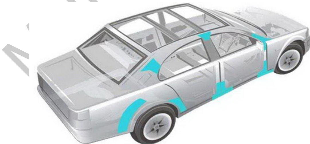
34. ábra. Gyártók által cellásított üregek
