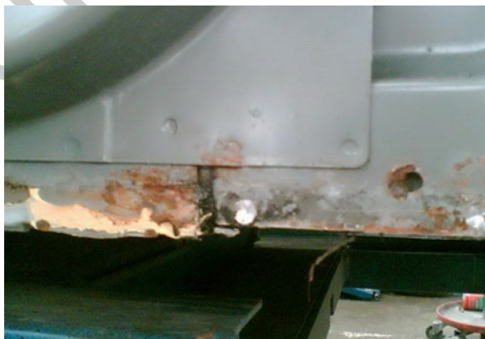
3. ábra. Szerkezetre veszélyes korrózió (küszöb)
