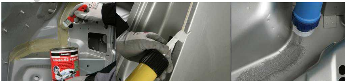
11. ábra. Háromfajta tömítési mód: ecsetelés, csíkként felvitt és szórt
