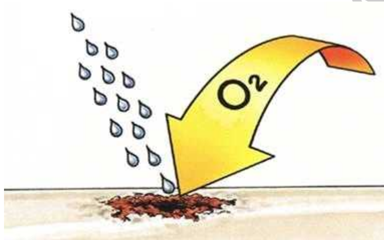
1. ábra. A korrózió létrejöttét segítő hatások
