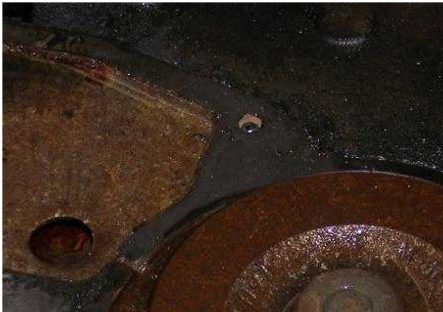
2. ábra. Korrodált gépjármű alvázelemek
