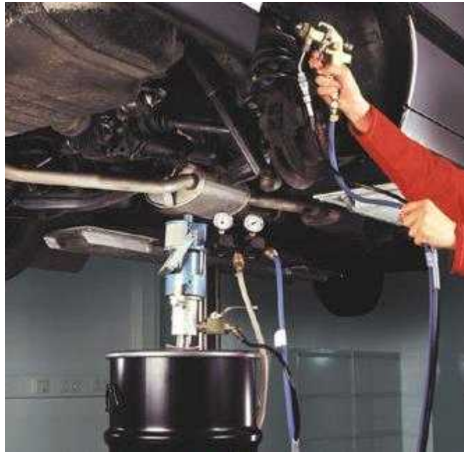
19. ábra. Bitumenes alvázvédő felszórása hordós kiszerezésből
