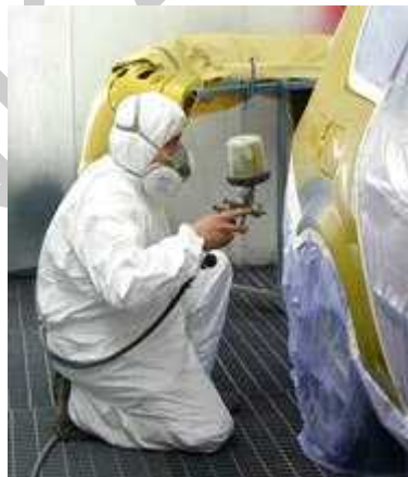
8. ábra. Kétkomponensű alapozó felhordása szórópisztoly segítségével.
