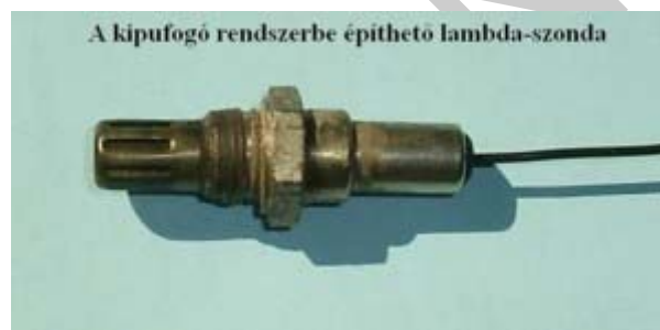
18. ábra. Lambdaszonda érzékelő
