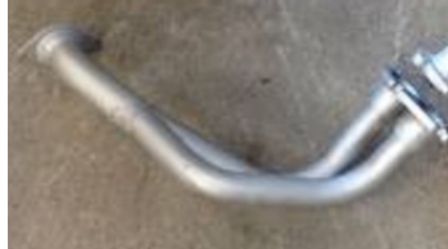
17. ábra. Kipufogó leömlőcső
