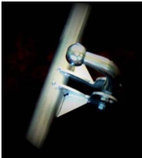
3. ábra. Csavaros kivitelű (szerelhető) vonóhorog fejkialakítás
