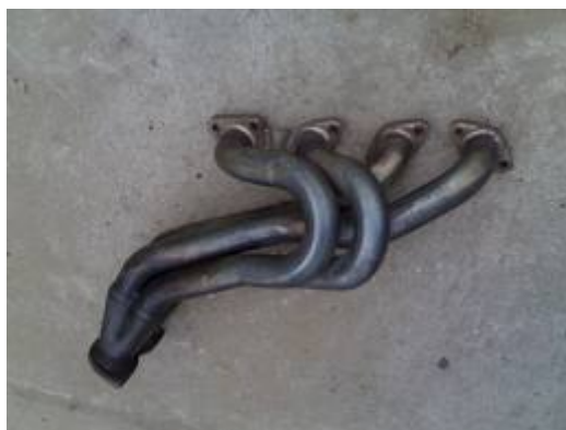
16. ábra. Kipufogó leömlőcsonk más kialakításban
