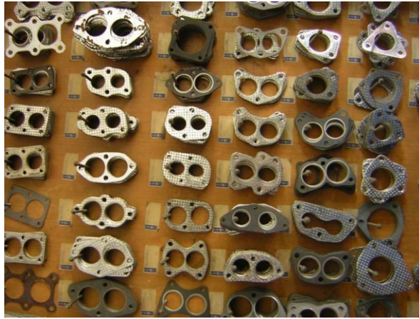
24. ábra. Típusfüggő tömítések
