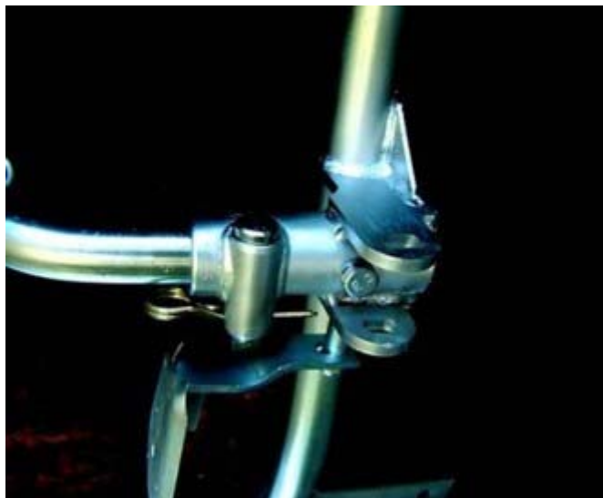
5. ábra. Excenteres rögzítésű vonófej
