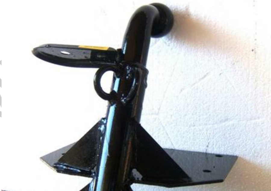
2. ábra. hegesztett kivitelű vonóhorog kialakítás
