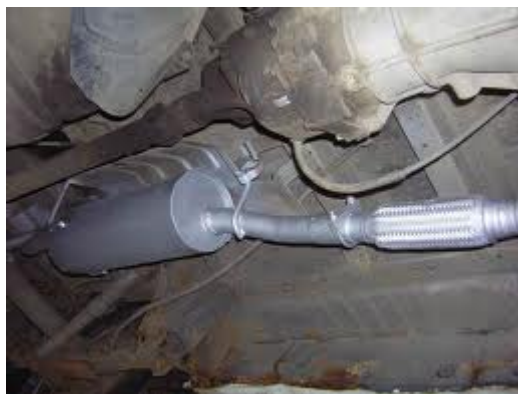
21. ábra. Folytó-tompító dob flexibilis csővel
