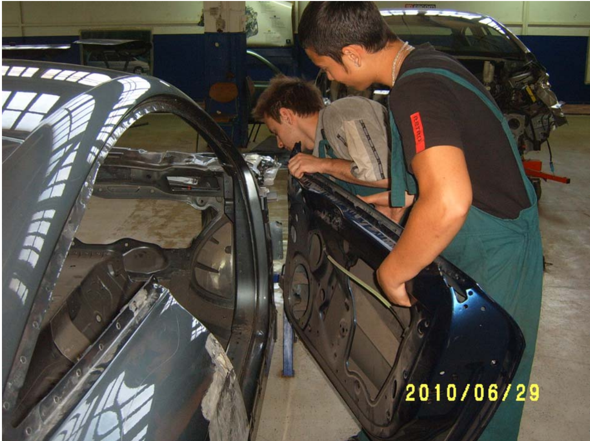
23. ábra. Ajtó levétele egyedül segédberendezéssel
