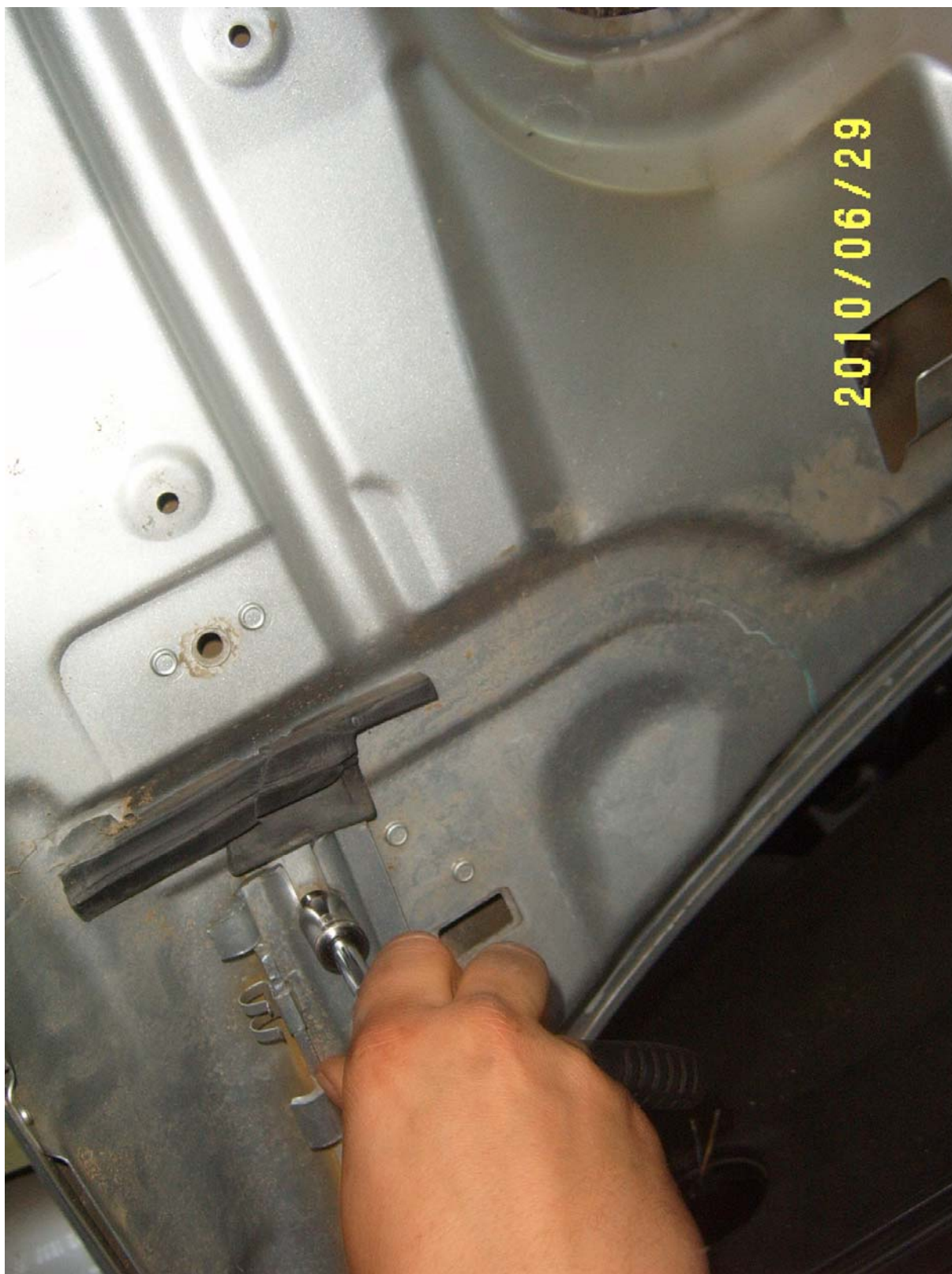
11. ábra. A rögzítő csavarok eltávolítása
