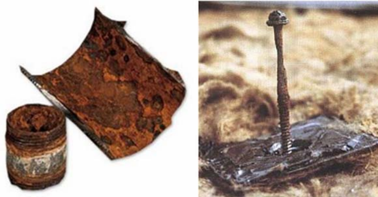
1. ábra. Erősen korrodált cső és Méreteiben eltéréseket mutató csavar
