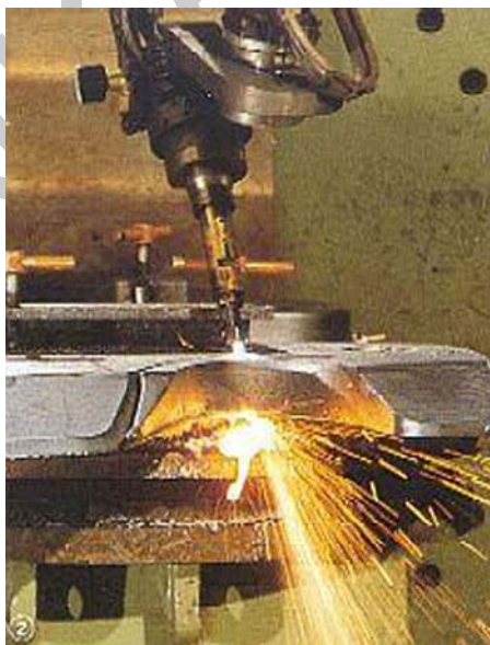
1. ábra. A lángvágás folyamata
