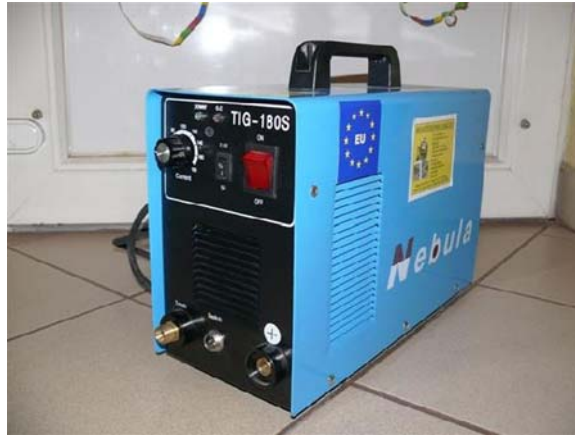
18. ábra. Hegesztő inverter
