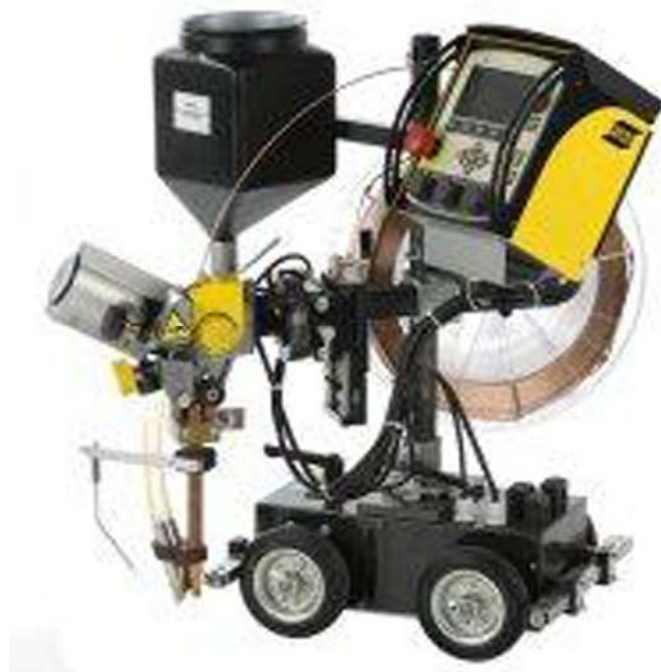
16.ábra. Fedett ívű hegesztő automata
