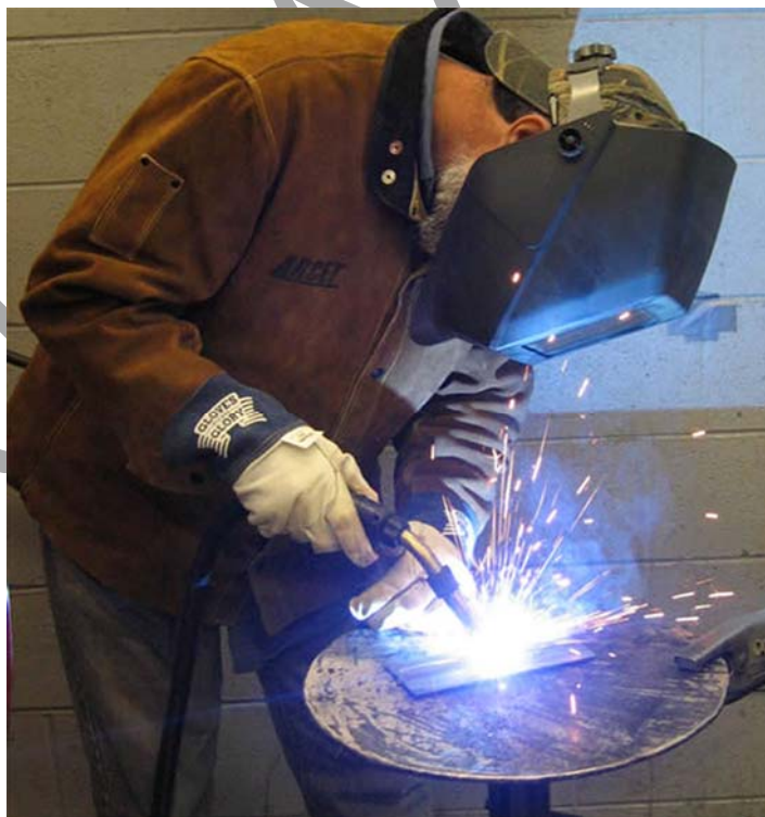
1.ábra. Az ívhegesztés munkafolyamata
