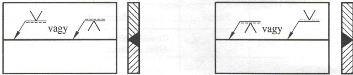
24. ábra. Rajzzel a varrat láthatóságának függvényében (Varrat a nyíl felőli oldalon. Látható - Varrat a másik oldalon, takart)
