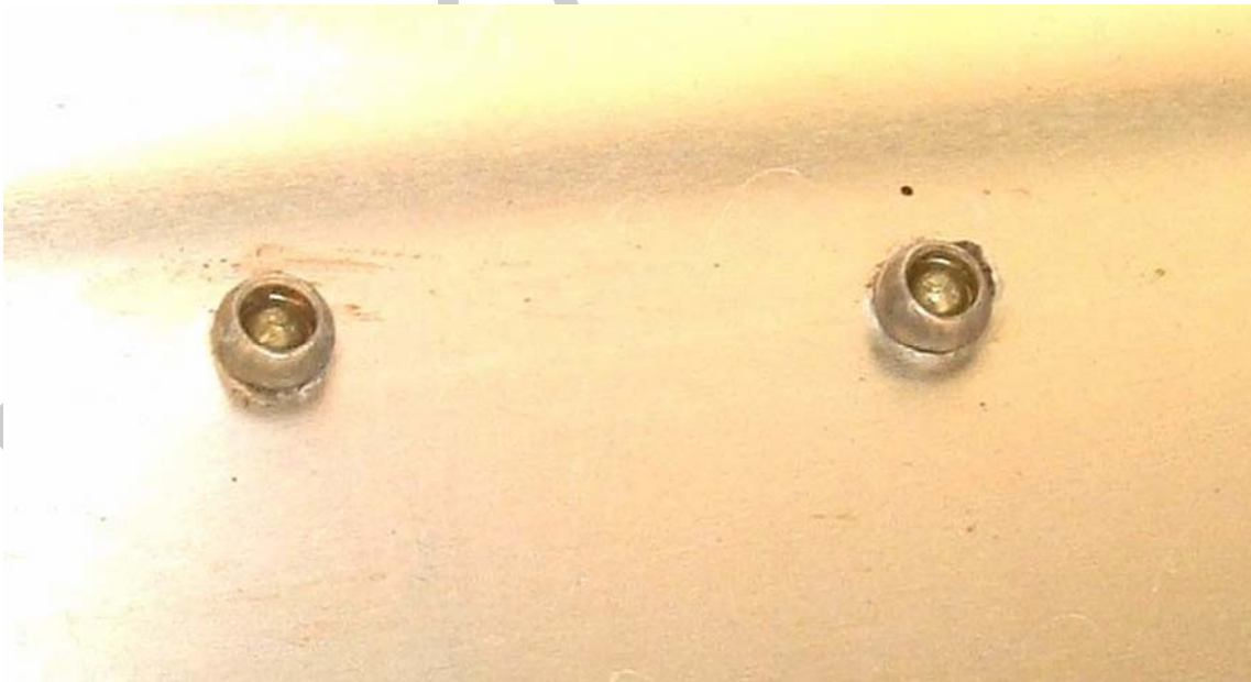
35. ábra. Zárófej kialakulása húzószegecsnél (POP szegecsnél)
