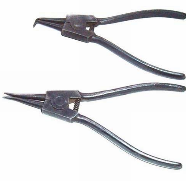
13. ábra. Rögzítőgyűrű (seeger gyűrű) fogó tengelyhez
