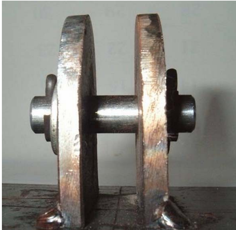
3. ábra. Fej nélküli furatos csapszeg alkalmazása
