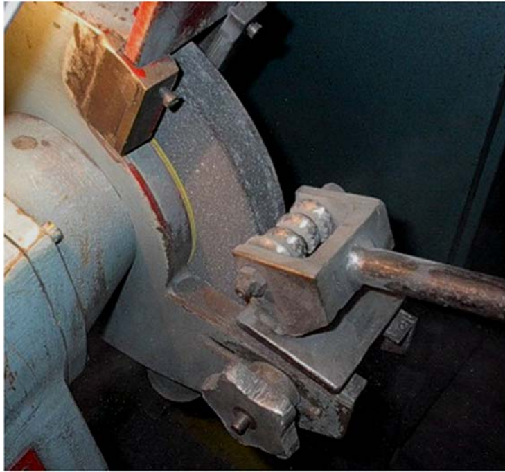
Korongszabályozás csillag szabályozóval (durva szabályozás)
