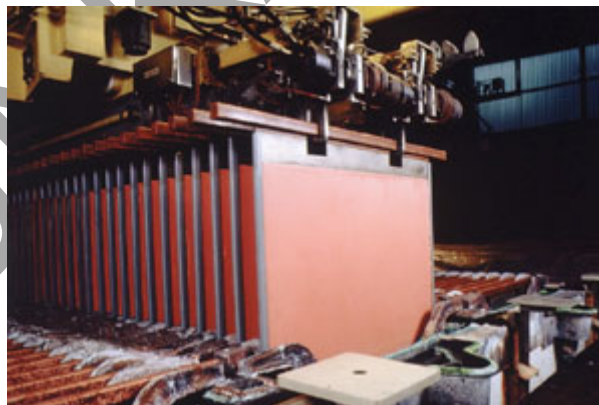
2. ábra. Katódrezt előállítása 2
