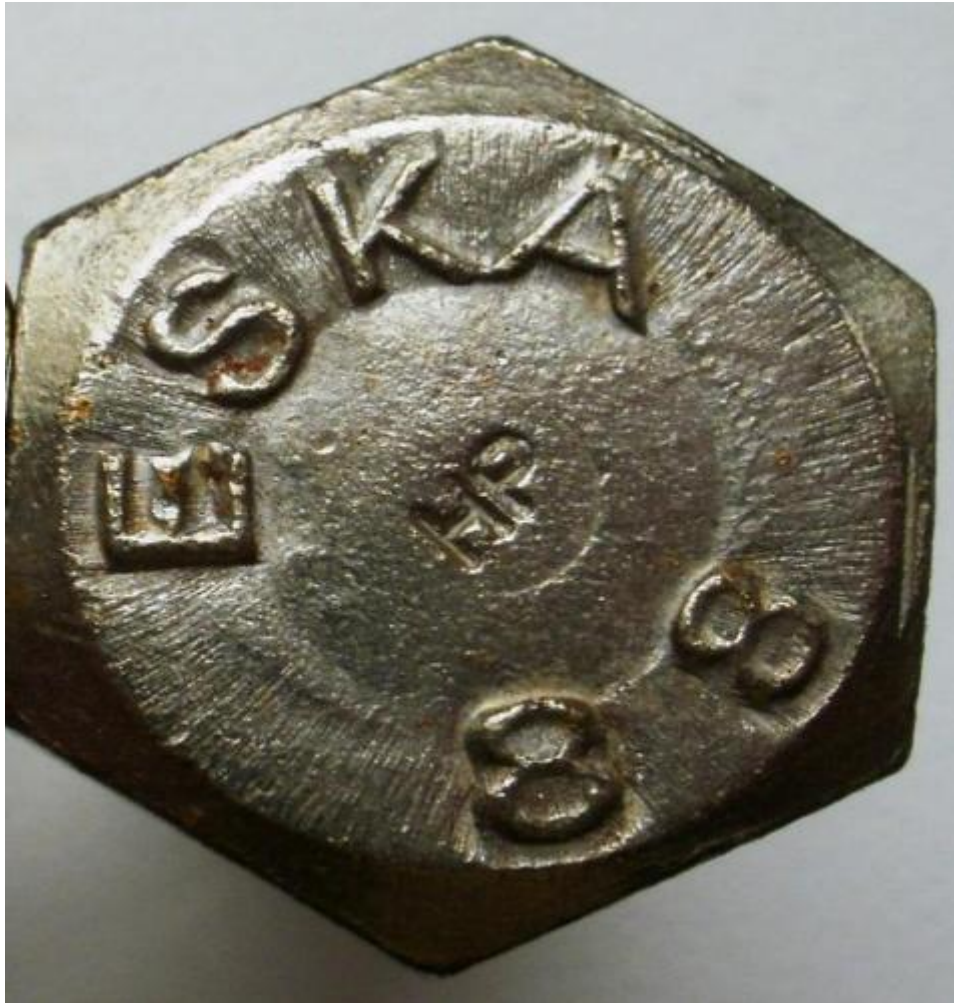
8. ábra. A szilárdsági osztály jelölése a csavarfejen
