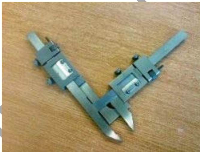
11. ábra: Fogvastagságmérő tolómérő
