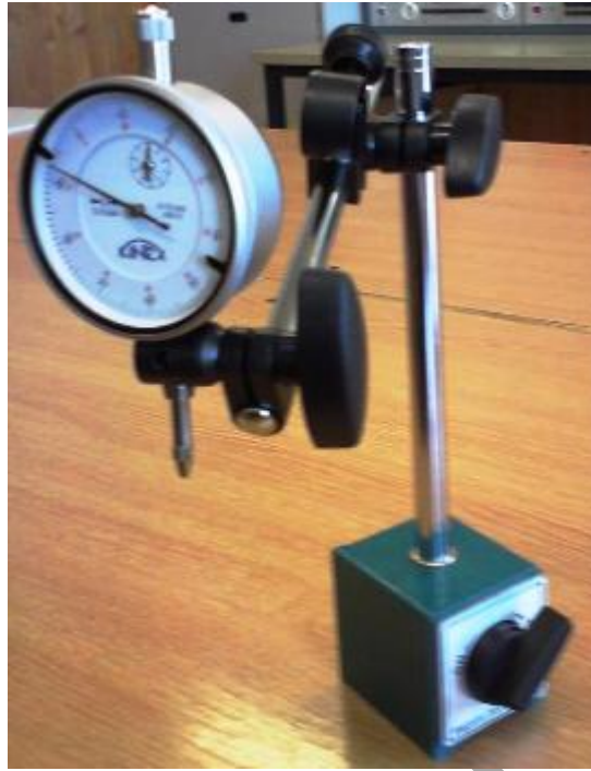
25. ábra: Mérőóra mágneses állványban
