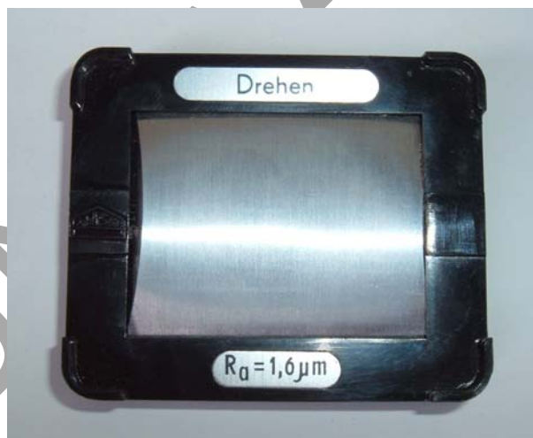
12. ábra. R_a 1,6-os érdesség minta
